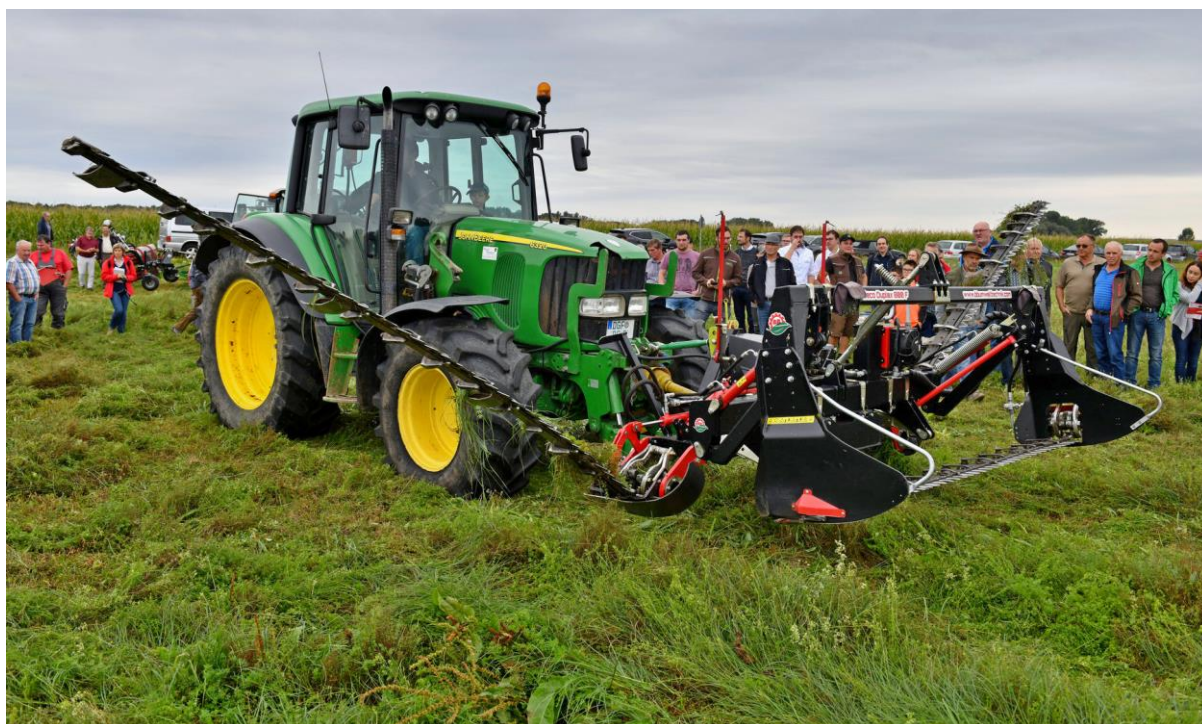
Schmetterlingsmähwerk der Firma BB Umwelttechnik mit Doppelmessertechnik mit 9 m Arbeitsbreite für große Wiesen und Landschaftspflegeflächen. Foto: M. Birgmann
